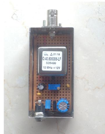
Seitenbandrauschkurve (links) und Einbau in Gehäuse mit Stromversorgung (rechts)
