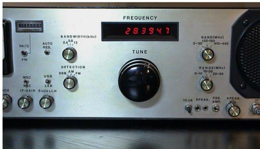
Bild 14: Analoger KW-Receiver, Frequenzbereich 0,1-30MHz, ohne Preselector,  $\text{IP}_3 = +26\text{dBm}$
