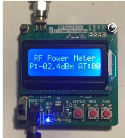
Rauschsignal 0dBm, Fehler: 2.4dB
