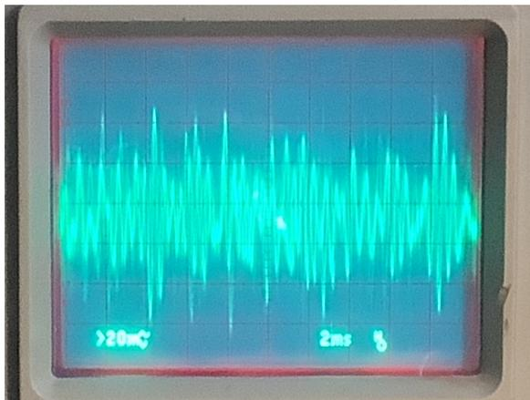
Bei konstanter Temperatur ist die Rauschleistung demnach direkt proportional zur Systembandbreite und es gilt  $P_{\text{Noise}} \sim B$ , was im völligen Gegensatz zu Sinussignalen steht. Die Bestimmung des mittleren Rauschpegels ( $U_{\text{eff}}$ ) ist oft schwierig, da die statistischen Schwankungen des Rauschens als ein „Rauschteppich“ wirken.
