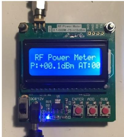
Bild 4: Sinussignal 0dBm, korrekt
