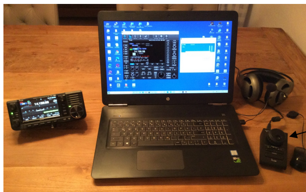
Bild 15: IC-705 Remote Control über ein Notebook, mit angeschlossenem Icom Remote Encoder
