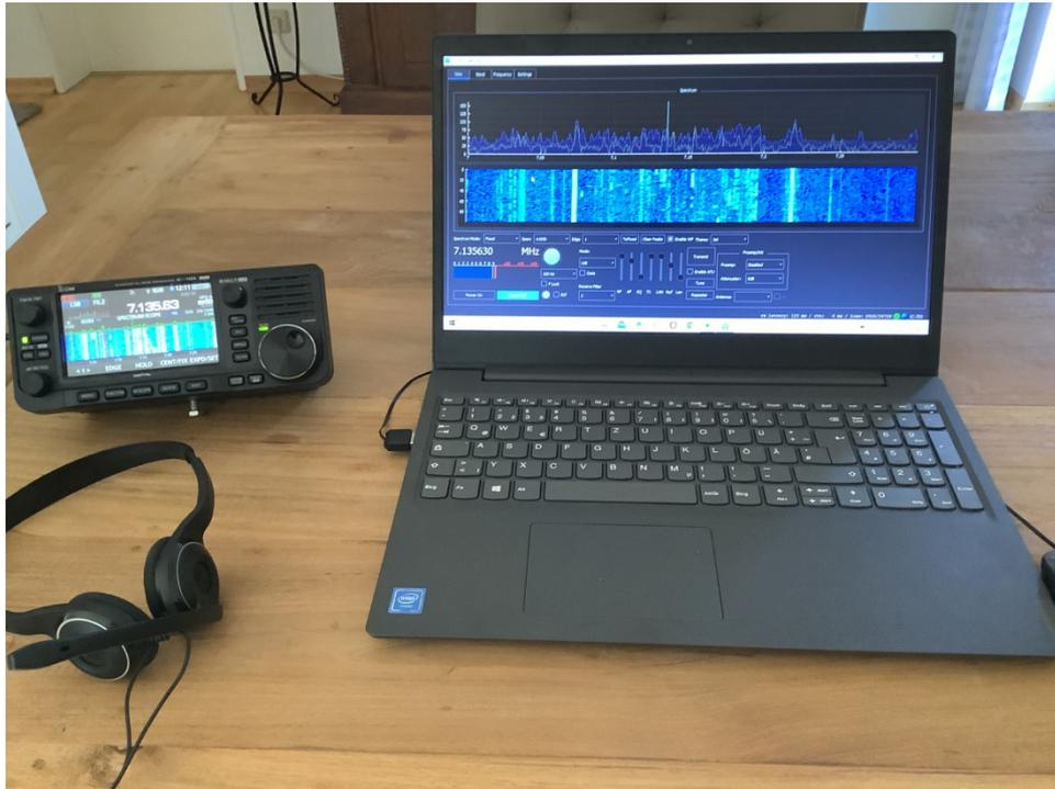
**Bild 1: Fernbedienung des IC-705 mit der Software "wfview"**
