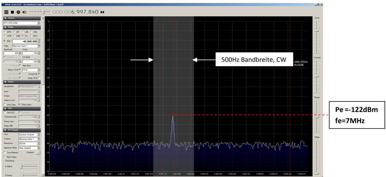
Bild 1: Signalpegel Pe=-122dBm für ein akustisches (S+N)/N = 3dB
