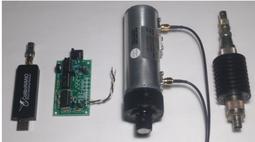
Bild 9: SDR-ColibriNANO, NF-Rauschgenerator, stellbares Dämpfungsglied, 20W-Abschlußwiderstand
