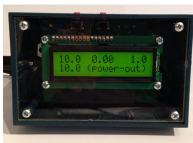
**Bild 7:** SWR-Power-Meter, Anzeigewert (PEP)=10Watt
