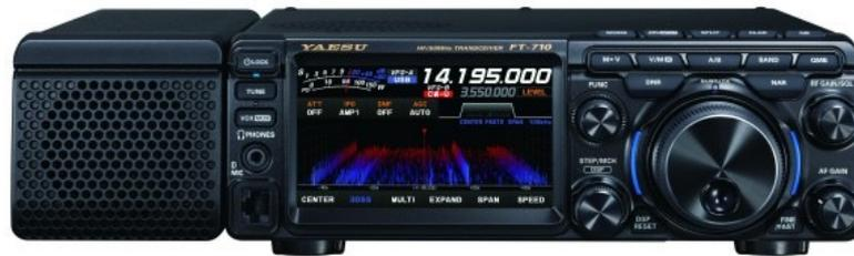
Der FT-710 ist ein moderner, direktabtastender KW/50/70MHz-Transceiver und zeichnet sich durch folgende Besonderheiten aus: HF-Direktabtastung mit Dual-Channel-ADC (14 Bit), 3DSS Echtzeit-Spectrum-Scope, RMDR 113dB in 2 kHz Abstand, Dithering-Signal, 4.3 Zoll Touch-Screen Farbdisplay, AESS (Acoustic Enhanced Speaker System), Anschluß für externen DVI-D-Monitor, Antennentuner und 100 Watt Sendeleistung.
